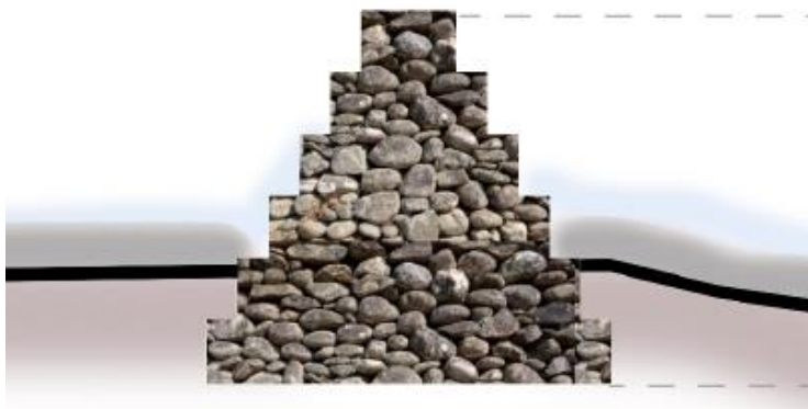
Imagen N° 114: Dique de retención de sedimentos - perfil
