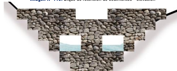
Imagen N° 115: Dique de retención de sedimentos - elevación
